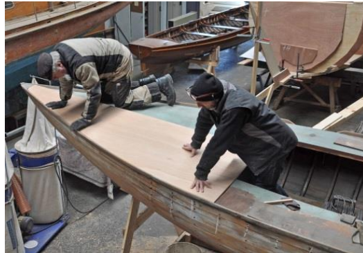
Leggen van een nieuw dek 8 februari 2018
